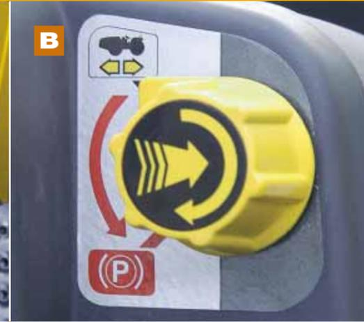
Freno di stazionamento ad inserimento automatico e disinnesto idraulico
