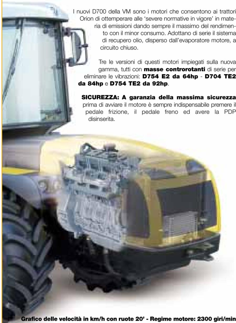
I nuovi D700 della VM sono i motori che consentono ai trattori Orion di ottemperare alle 'severe normative in vigore' in materia di emissioni dando sempre il massimo del rendimento con il minor consumo. Adottano di serie il sistema di recupero olio, disperso dall'evaporatore motore, a circuito chiuso.
