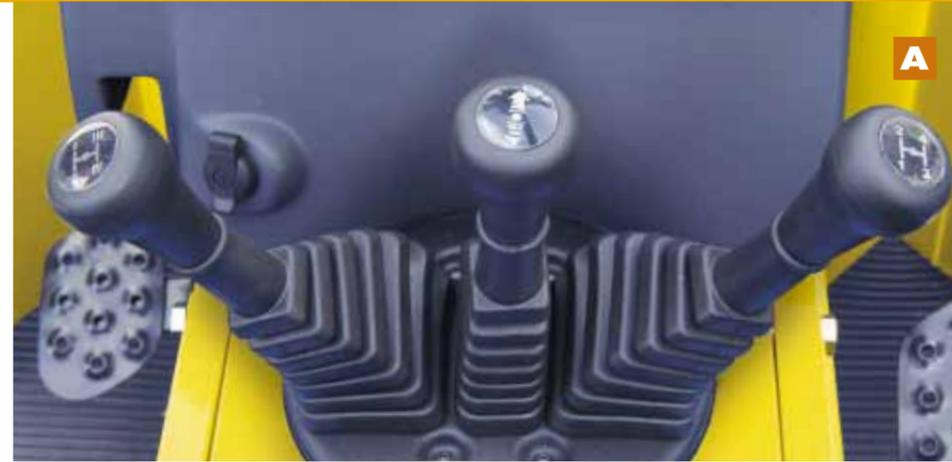
Il Cambio sincronizzato (fig. A) è a 32 velocità: 16 avanti - 16 retromarce con inversore sincronizzato, senza sovrapposizione di velocità nelle varie gamme, permette di adattare i rapporti alle esigenze specifiche di ogni operatore per qualsiasi utilizzo.
