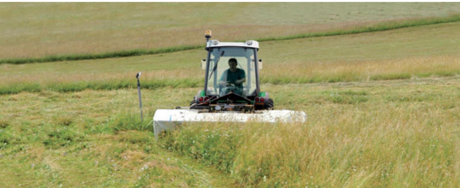
Il sistema si avvale di due cilindri collegati ad un impianto idraulico indipendente dotato di un accumulatore ad azoto che, affiancati a quelli in dotazione al sollevatore posteriore, assicurano la sospensione dell'attrezzo in modo autonomo rispetto allo stesso sollevatore.
